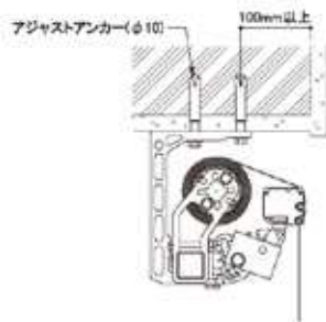
▼コンクリート造天井納まり
